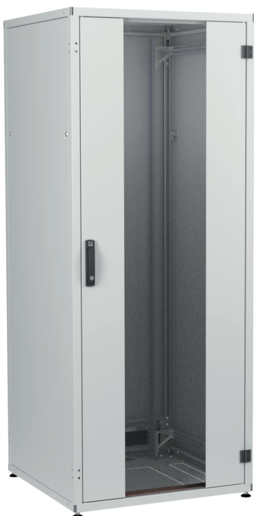
Szafa SZB IT o wysokości 42 U szerokości i głębokości 800 mm z drzwiami przednimi typu "6" (drzwi szklane z bokami metalowymi).
