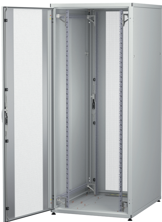
Szafa SZB IT o wysokości 42 U szerokości 800 mm i głębokości 1000 mm z drzwiami przednimi typu "4" (drzwi przednie i tylne perforowane z zamkiem baskwilowym trzypunktowym).
