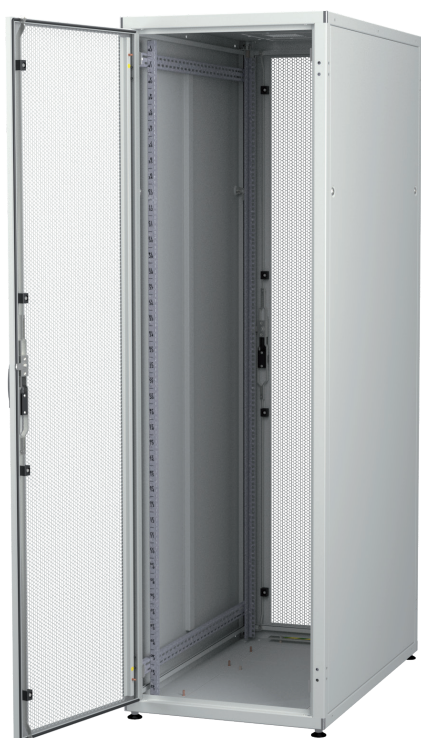
Szafa SZB IT o wysokości 42 U szerokości 600 mm i głębokości 1000 mm z drzwiami przednimi typu "4" (drzwi przednie i tylne perforowane z zamkiem baskwilowym trzypunktowym).
